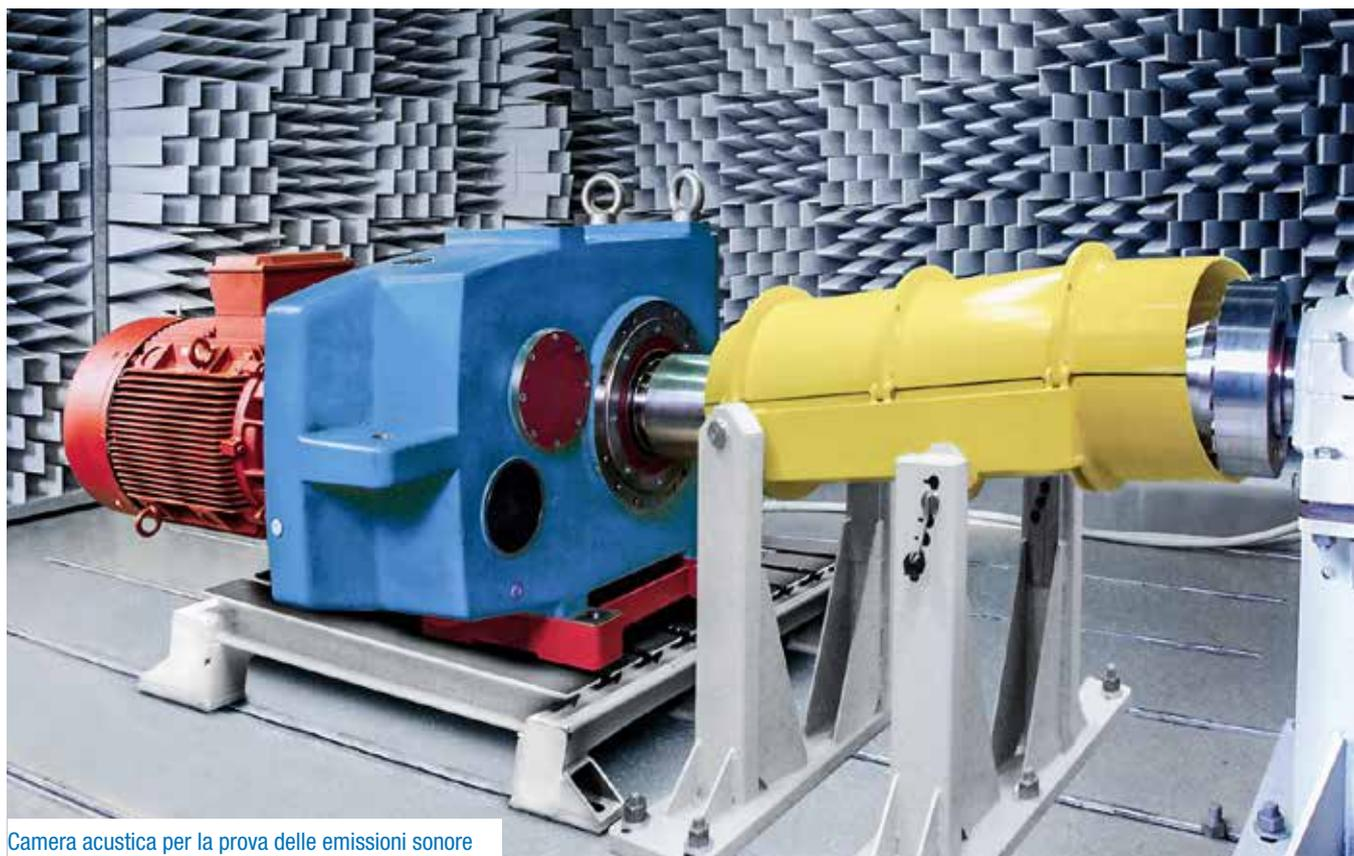
Camera acustica per la prova delle emissioni sonore
