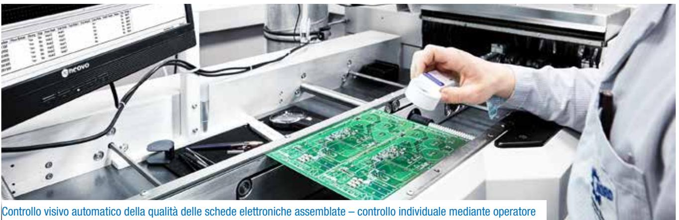
Controllo visivo automatico della qualità delle schede elettroniche assemblate – controllo individuale mediante operatore
